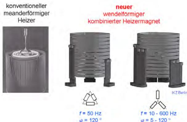
Abb. 1: Heizerkonfigurationen aus Graphit für die konventionelle Czochralski-, LEC- und VCz-Züchtung (links) und für die gleichzeitige Erzeugung von Wärme und magnetischen Wanderfeldern in Dreieckschaltung (Mitte) und Sternschaltung (rechts).
