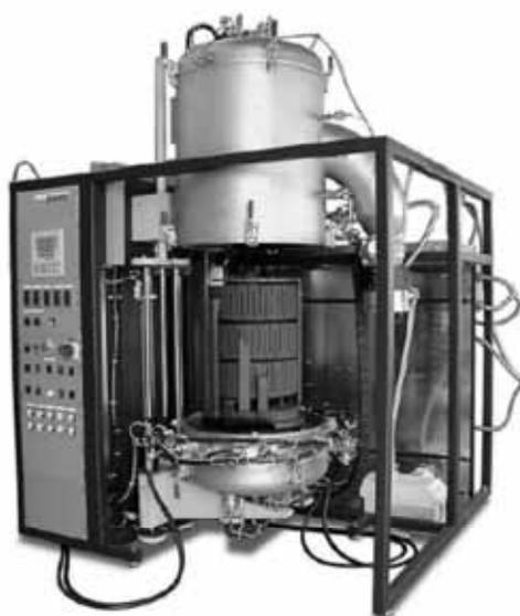
KZV Kristallziehanlage mit Leistungsregelung für Fluoride nach dem Stockbarger- oder Bridgman-Verfahren bis 1800°C
