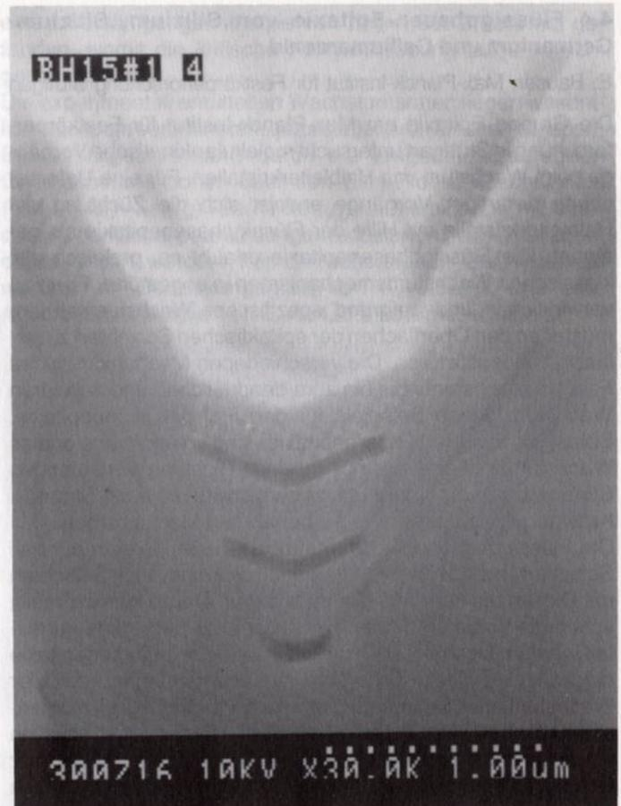
Fig. 4 GaInAs-"Draht" in einem InP-V-Graben
