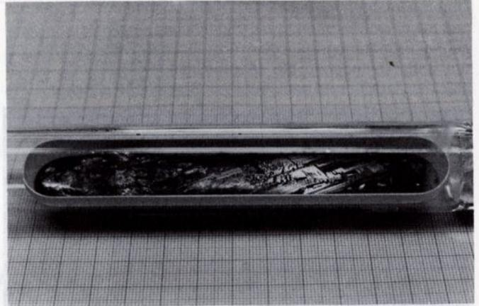
Abb. 5:  $\text{CuInS}_2$ -Barren, gezüchtet durch "gradient freezing" bei einem Temperaturgradienten von  $15\text{ K}/\text{cm}$  und einer Abkühlgeschwindigkeit von  $1\text{ K}/\text{h}$ . Tiegelmaterial: PBN.
