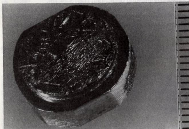
Abb. 8: Foto eines  $\text{Al}_{0,07}\text{Ga}_{0,93}\text{Sb}$ -Kristalls mit 2 mm Dicke und 15 mm Durchmesser, gewachsen mit LPEE auf einem GaSb-Substrat [Kristallographisches Inst./Universität Freiburg]
