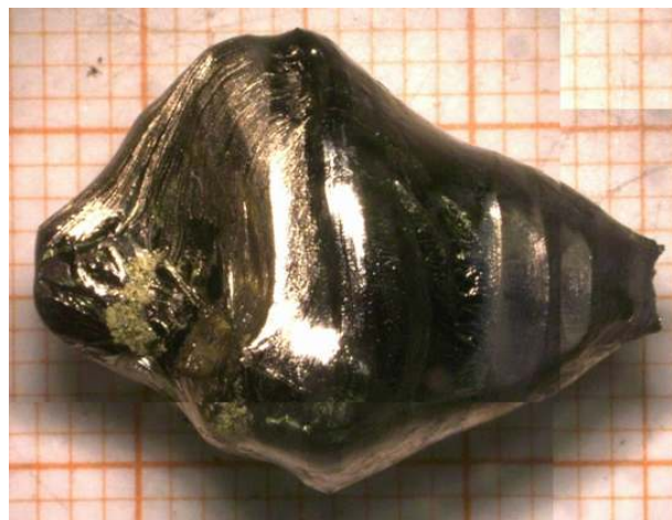
Abb. 1: \text{EuPd}_2\text{Si}_2 -Züchtungskörper, der mittels Czochralski-Verfahren aus einer schwebenden Schmelze gezogen wurde. Die orange Skala im Hintergrund ist mm-Papier. (Bild: M. Peters)
