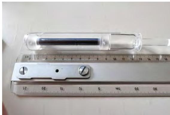
Terrestrische Vergleichsprobe des ParSiWal-Experimentes: Siliziumstab mit dem Partikeldepot (nicht sichtbar), der in einer Quarzglasampulle gehalten wird. Der Stab mit Ampulle wird in die Spiegelofenanlage ELLI eingebaut. Bild: Universität Freiburg
