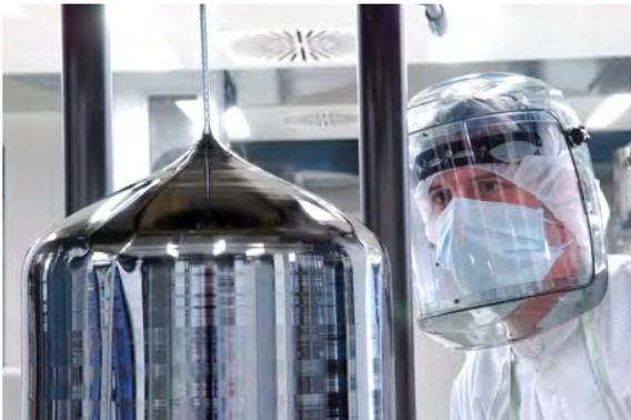
Siliziumkristall mit 300 mm Durchmesser, hergestellt in Freiberg nach dem sogenannten Czochralski-Verfahren, das vor 100 Jahren von Prof. Jan Czochralski erfunden wurde. Bild: Siltronic AG
