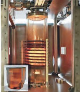
Das Titelbild dieser Ausgabe zeigt einen Aluminiumnitrid-Kristall aus dem IKZ (kleines Bild) vor einem Blick in die dazugehörigen Zuchtungsanlage. Der Kristall hat einen Durchmesser von ca. 10 mm und die (0001̄)-Wachstumsfläche befindet sich oben.
