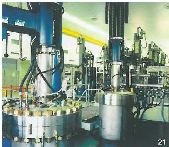
1998 werden die Anlagen für die Massenproduktion von GaAs nach dem Liquid-Encapsulated Czochralski-Verfahren in Betrieb genommen. Foto: FCM-Archiv
