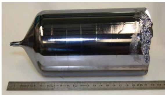
Abbildung 1: Das Bild zeigt einen 9 kg GaAs:Si Kristall, welcher mit einem dem Wachstumsverlauf angepassten Doppelfrequenz-TMF gezüchtet wurde. Die äußerlichen Streifen stammen von Magnetfeld-Markierungen.
