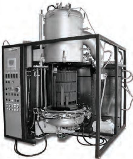
KZV Kristallziehanlage mit Leistungsregelung für Fluoride nach dem Stockbarger- oder Bridgman-Verfahren bis 1800°C
