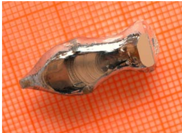
Monokliner \text{Al}_{76.7}\text{Cr}_{0.5}\text{Fe}_{22.8} -Einkristall gezogen nach dem Czochralski-Verfahren aus Al-reicher Lösung der Ausgangszusammensetzung \text{Al}_{91}\text{Cr}_1\text{Fe}_8 . (Ziehrichtung senkrecht (001), Ziehgeschwindigkeit 0,05 mm/h, Starttemperatur 1020^\circ\text{C} ) Foto: B. Bauer
